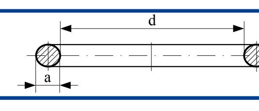
**Uszczelnienie typu O-ring (RO)**
